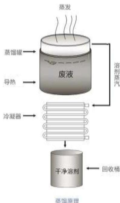
图 2.2.1-1 本项目蒸馏原理示意图
